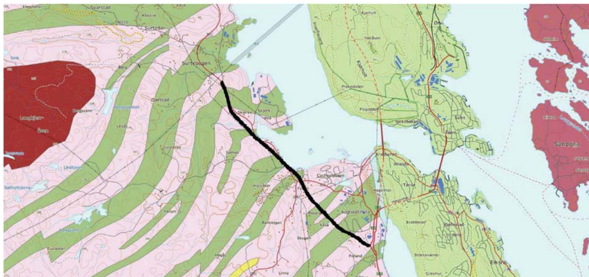
Bilde 1: Geologisk berggrunnskart fra NGU med planlagt vegtrase. Grønn farge er amfibolitt og glimmerskifer. Rosa farge er granittisk gneis
